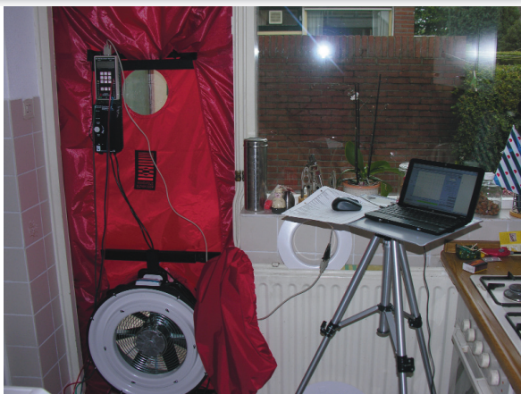
De opstelling van de BlowerDoor vóór de renovatie van VTB
