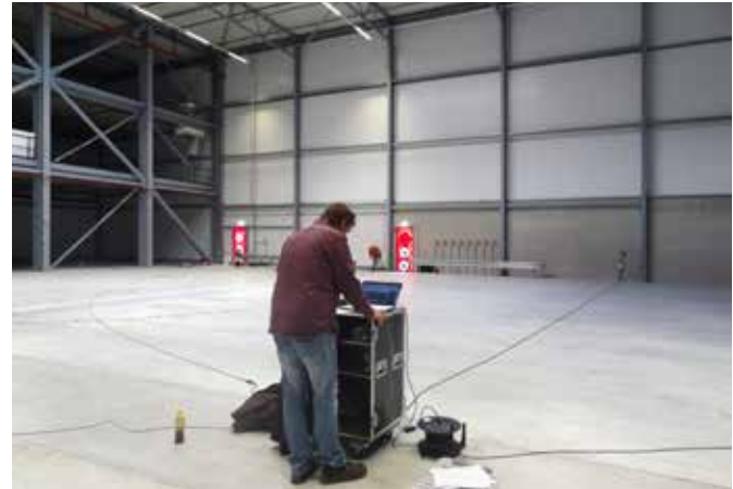
Meettechnicus leest de luchtdichtheidsmetingen uit.
